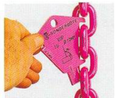
Prüfen Plastische Längung durch Überlast.
