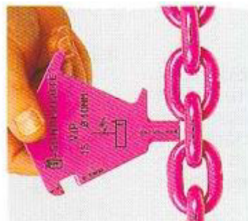
Prüfen Teilungsverlängerung durch Nenndickenverschleiß.
