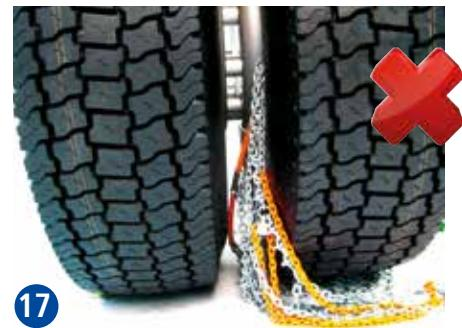
... oder im Felgentopf hängt. Vor Anfahren müssen unbedingt beide **Bügelenden** flach auf dem Boden liegen und aus dem Fahrbereich herausgedreht sein.
