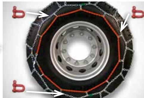
**Verwahrhaken** unter leichter Spannung in **Außenkette** einhängen. Beim nächsten Halt Sitz und Spannung der Kette prüfen. Bei richtiger Montage erübrigert sich ein Nachspannen. Nur mit fertig montierter Kette weiterfahren.
