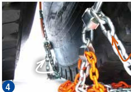
Das zweite **Bügelende** in gleicher Weise hinter den Reifen schieben, dabei nach unten ziehen, bis der **Bügel** hinter der Reifenlauffläche zusammenfedert.
